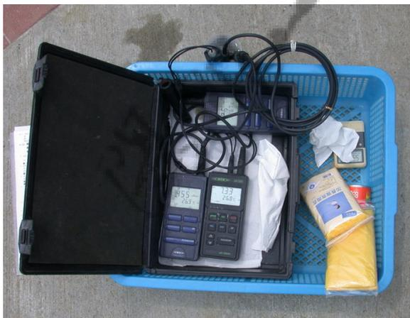
圖 3.3-3 攜帶式水質監測儀器
