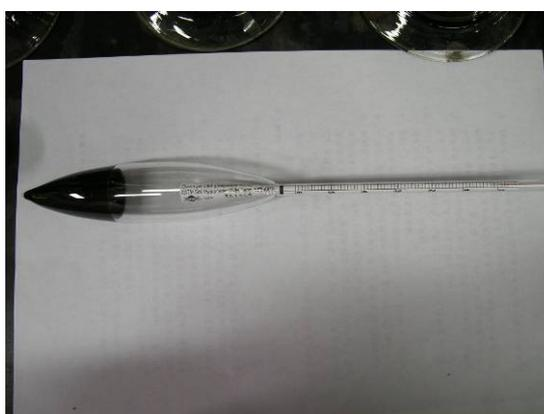
圖 3.4-6、土壤質地試驗使用之比重計
