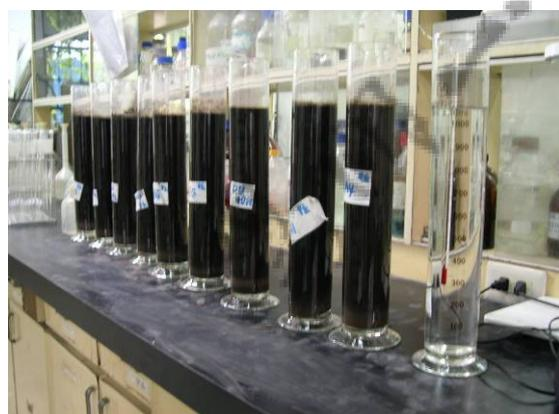
圖 3.4-5、土壤質地特性試驗情形
