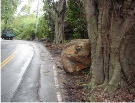
相片 13. 陽投公路鄰近第二展望台前約 500 公尺處，發生落石現象，落石直徑約 1.5M。
