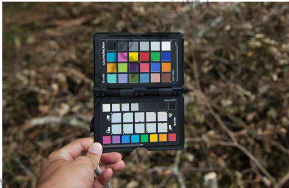
此圖的 ColorChecker 上方的色塊色彩相當飽和，但下方的淺色區則曝光稍嫌多了一些，下方白平衡區塊(紅色方框中)的色彩呈現有些誤差不是正確的色彩，(再依據此張相片的拍攝數值減少設定，去調整相機的數值，以達到正確的曝光。)
