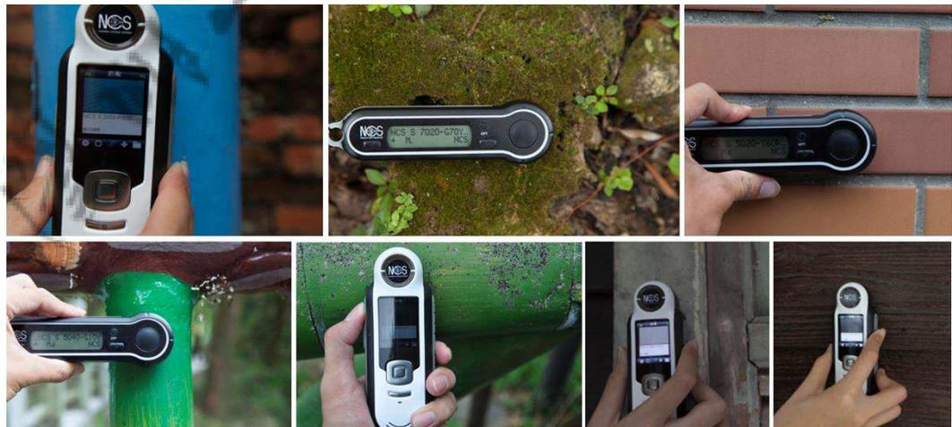
圖 5-13 測色儀器量測操作方式
