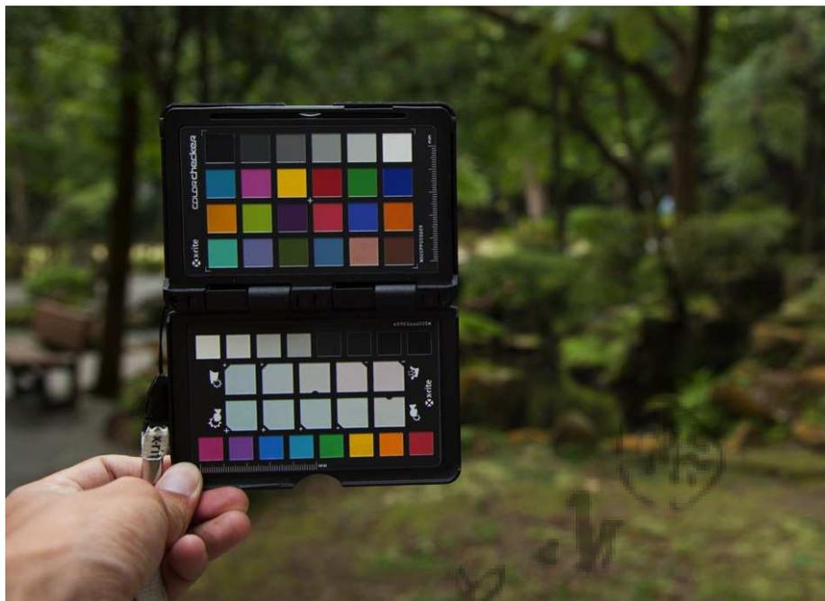
此圖 ColorChecker 下方的淺色部分曝光是正確的，但上方的色塊卻嫌不足。可知當前數位相機曝光值的設定會依選用的測光方式不同而有不同，其結果也有相當大差異。而現場環境、當時光線的條件不同亦會使色彩的表現有所不同，因此不能僅使用一個固定的設定曝光值持續拍攝。
