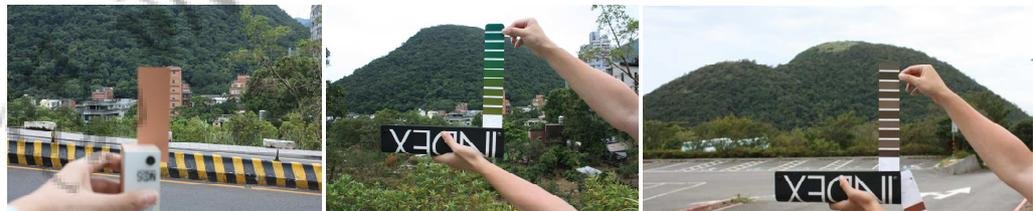
圖 5-11 遠距離色彩量測操作方式
