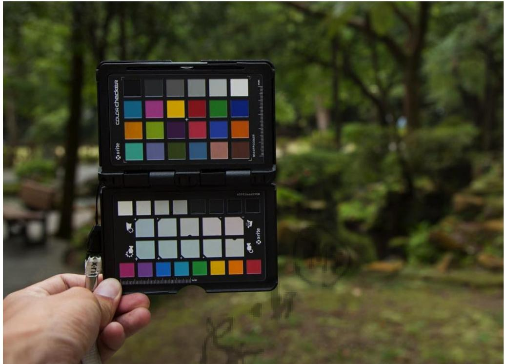
此圖 ColorChecker 下方的淺色部分曝光是正確的，但上方的色塊卻嫌不足。可知當前數位相機曝光值的設定會依選用的測光方式不同而有不同，其結果也有相當大差異。而現場環境、當時光線的條件不同亦會使色彩的表現有所不同，因此不能僅使用一個固定的設定曝光值持續拍攝。
