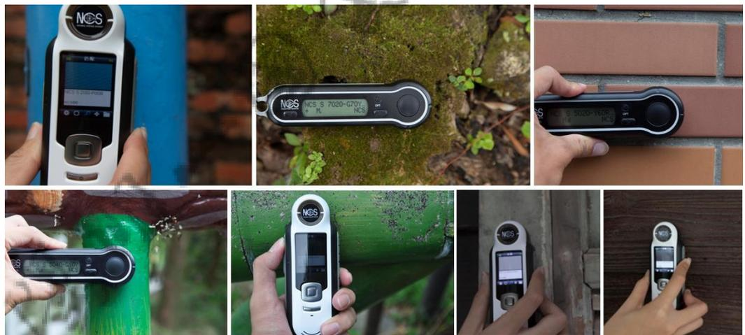
圖 13 測色儀器量測操作方式
