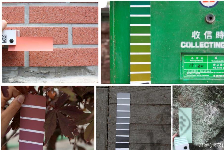
圖 5-12 近距離色彩量測操作方式
