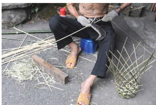
第一步：材料製作（切製竹材）
