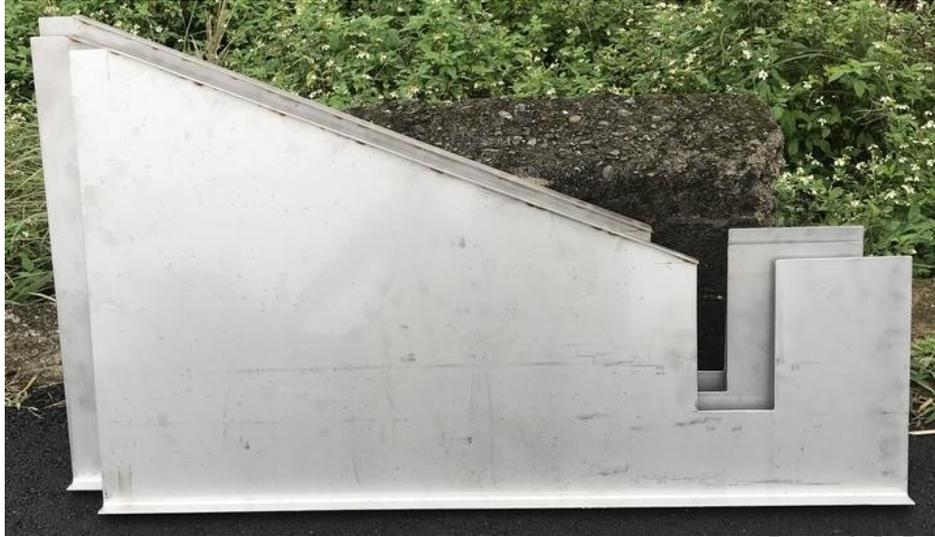
照片 三-4 新設計魚梯檔板，不鏽鋼製
