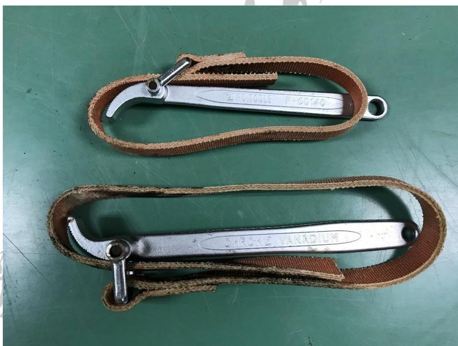
圖 2 透明管銜接油任拆裝工具---皮帶板手
