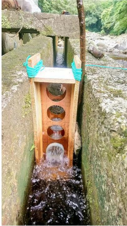
照片 三-27 水管式魚道出口陷阱設置
