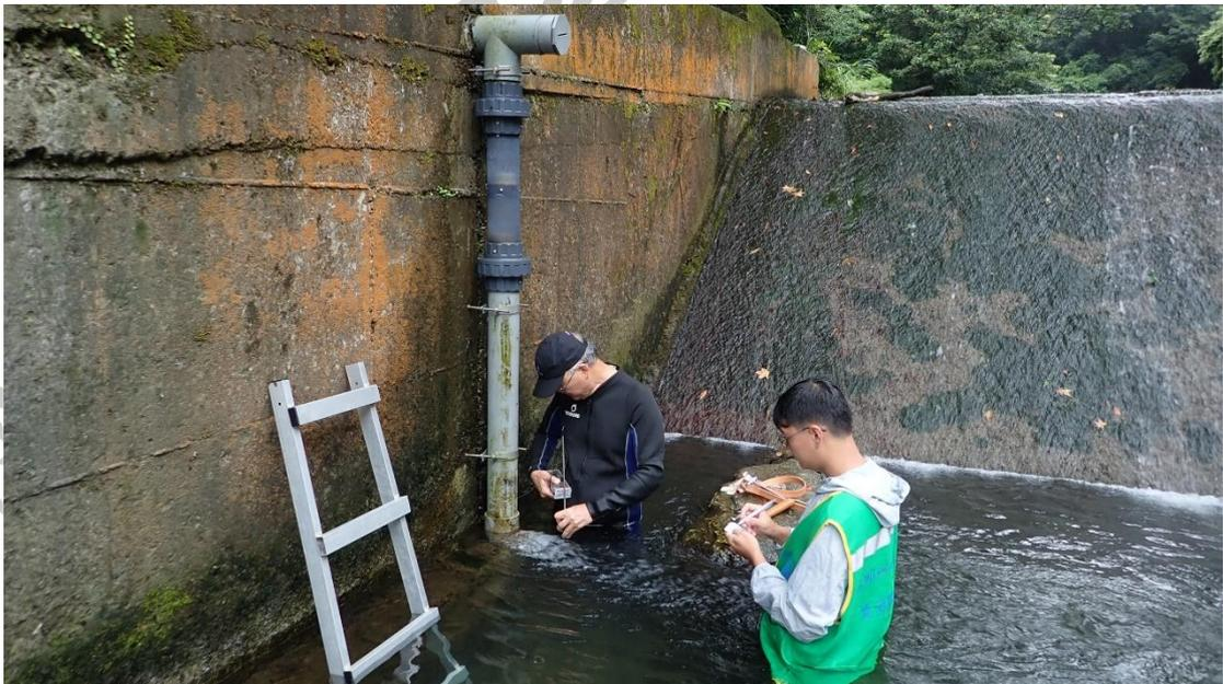
照片 三-23 管狀魚道量測流速的情形 2019/07/17
