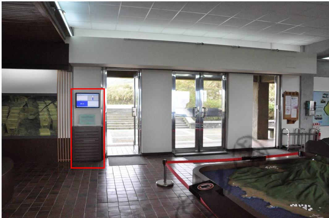
圖三十八 噴氣孔之溫度展示區位置（圖中左方紅色框）。展示區位於遊客中心一進大門的右側，暗棕色木箱內置電腦和溫度紀錄器，木箱上置放此系統之解說牌，牆壁上的26吋螢幕則展現噴氣孔之即時溫度。
