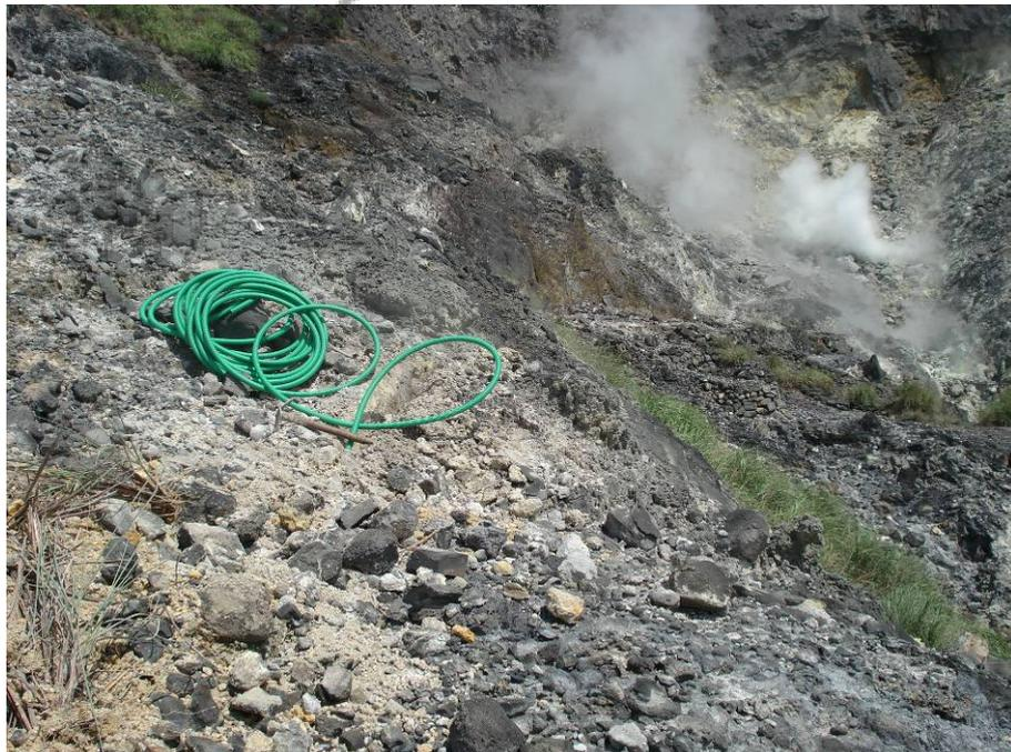
圖三十五 溫度感應器設置位置圖。長 40 公分的溫度感應器插入噴氣孔，溫度訊號經由纜線（圖中綠色鐵弗龍為保護訊號纜線之外殼）傳回至遊客中心。
