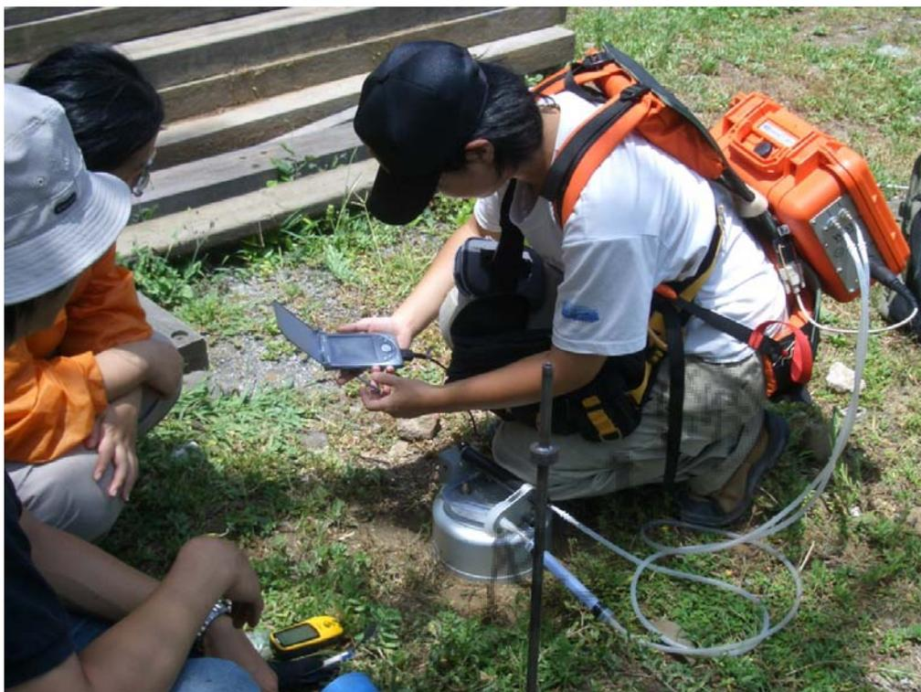
圖八 使用密閉氣罩法及套裝通量測量設備之工作情形。
