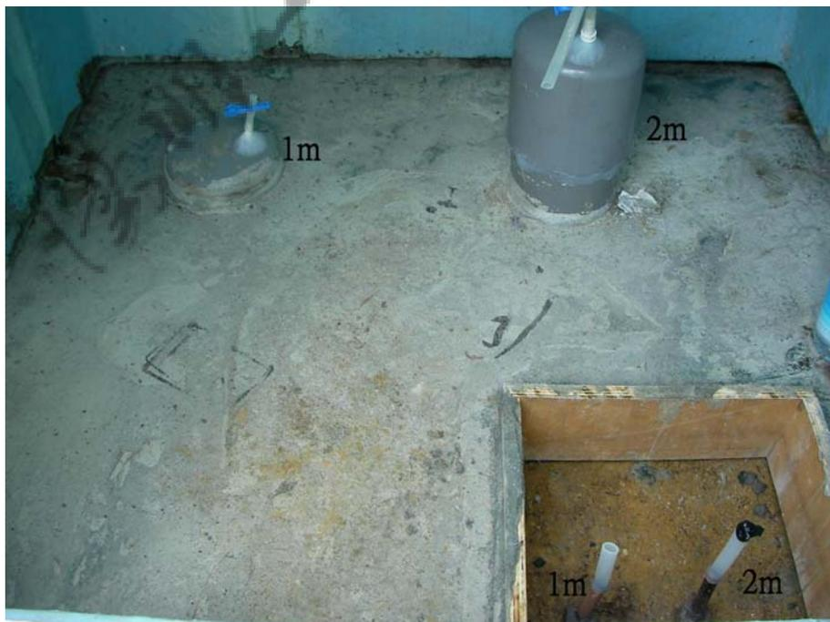
圖十五 火山氣體監測站之內預留不同深度的孔洞，可供二氧化碳與氬氣分析儀使用。
