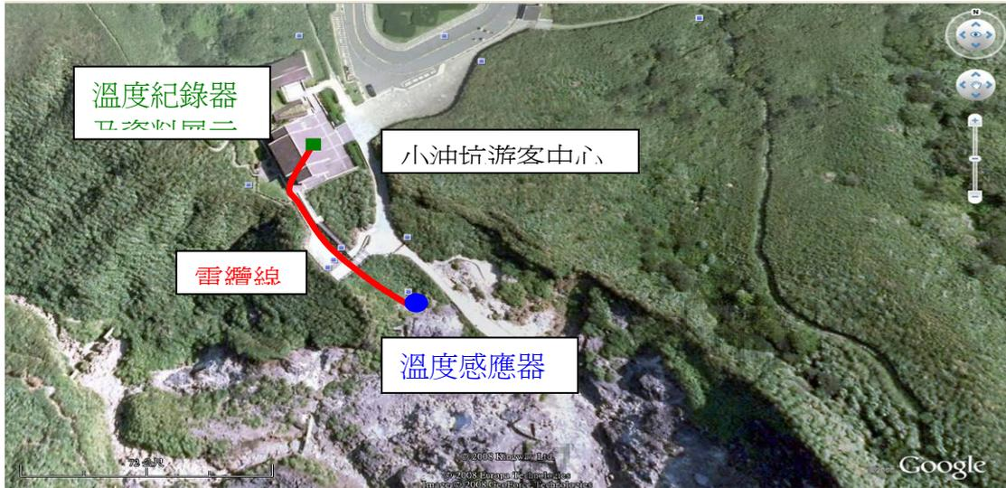
圖三十四 噴氣孔溫度監測系統示意圖。藍色實心圓為溫度感應器，紅色實線為防腐蝕性電纜線，電纜線長度約 150 公尺，為傳輸溫度訊號用，綠色方塊為溫度記錄器和溫度展示螢幕（位於遊客中心內）。
