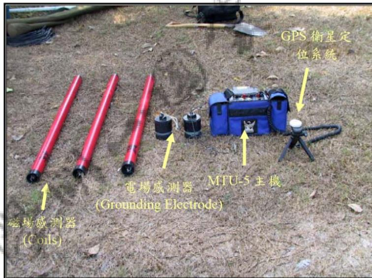
圖二十七 大地電磁儀系統: MTU-5A，包括主機其收訊頻寬範圍約 1/1800 Hz ~384 Hz，電場感測器，磁場感測器以及衛星全球定位系統(GPS)。
