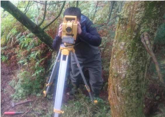
圖 13、全測站進行水井座標及高程調查作業
