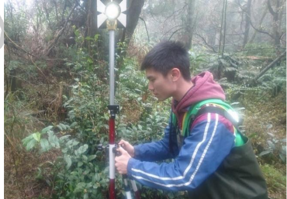
圖 13、全測站進行水井座標及高程調查作業
