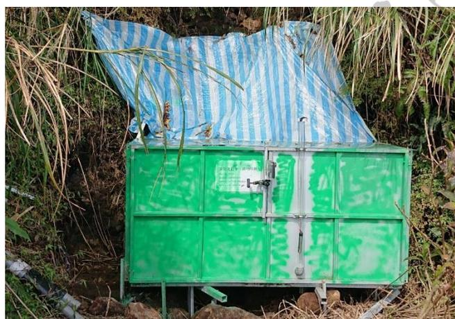
圖 11 堰槽式量水堰現地照片
