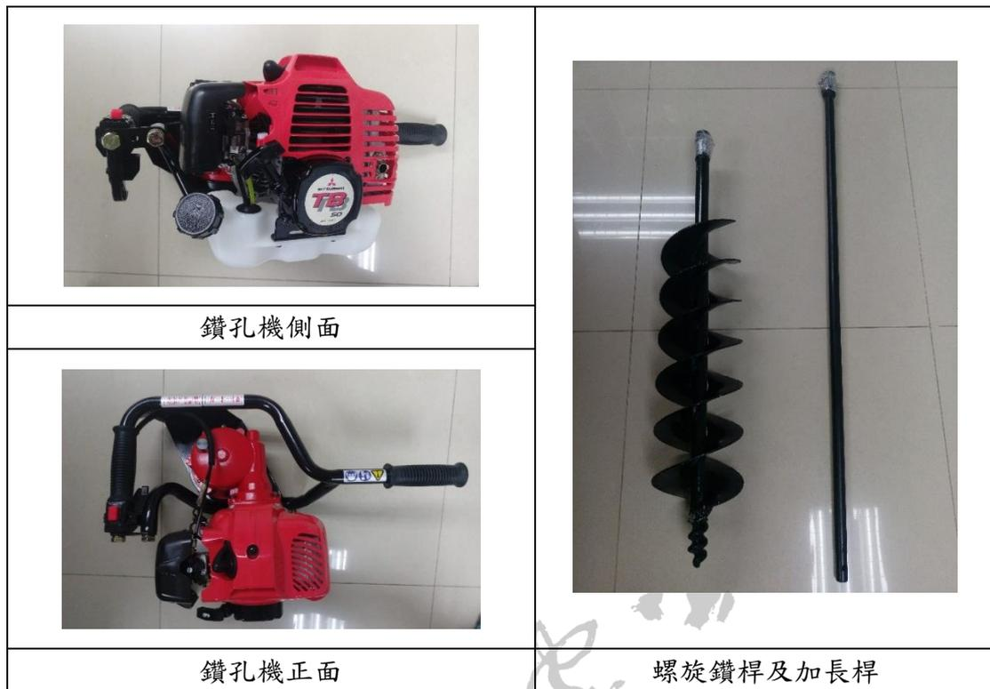
圖 21 手持式鑽孔機機具圖
