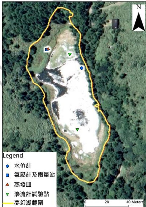
圖 56 水位儀器設置及入滲試驗位置
