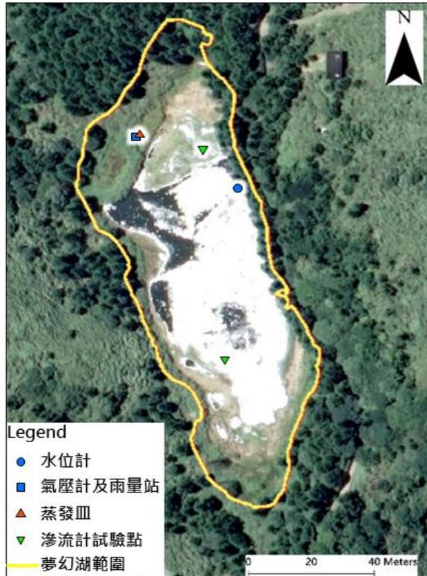
摘圖 3 水文儀器設置及入滲試驗位置
