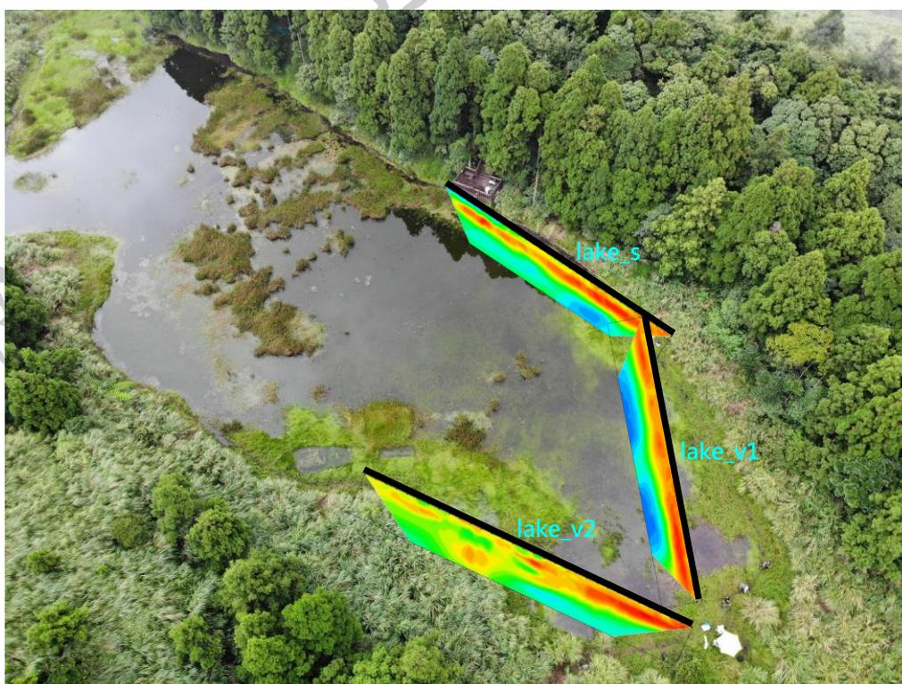
圖 85 夢幻湖湖區南側三條地電阻影像剖面（Dipole-dipole Array）
