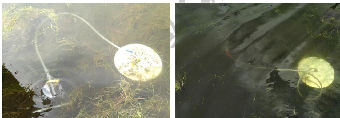
圖 59 滲流計現地安裝測試圖
