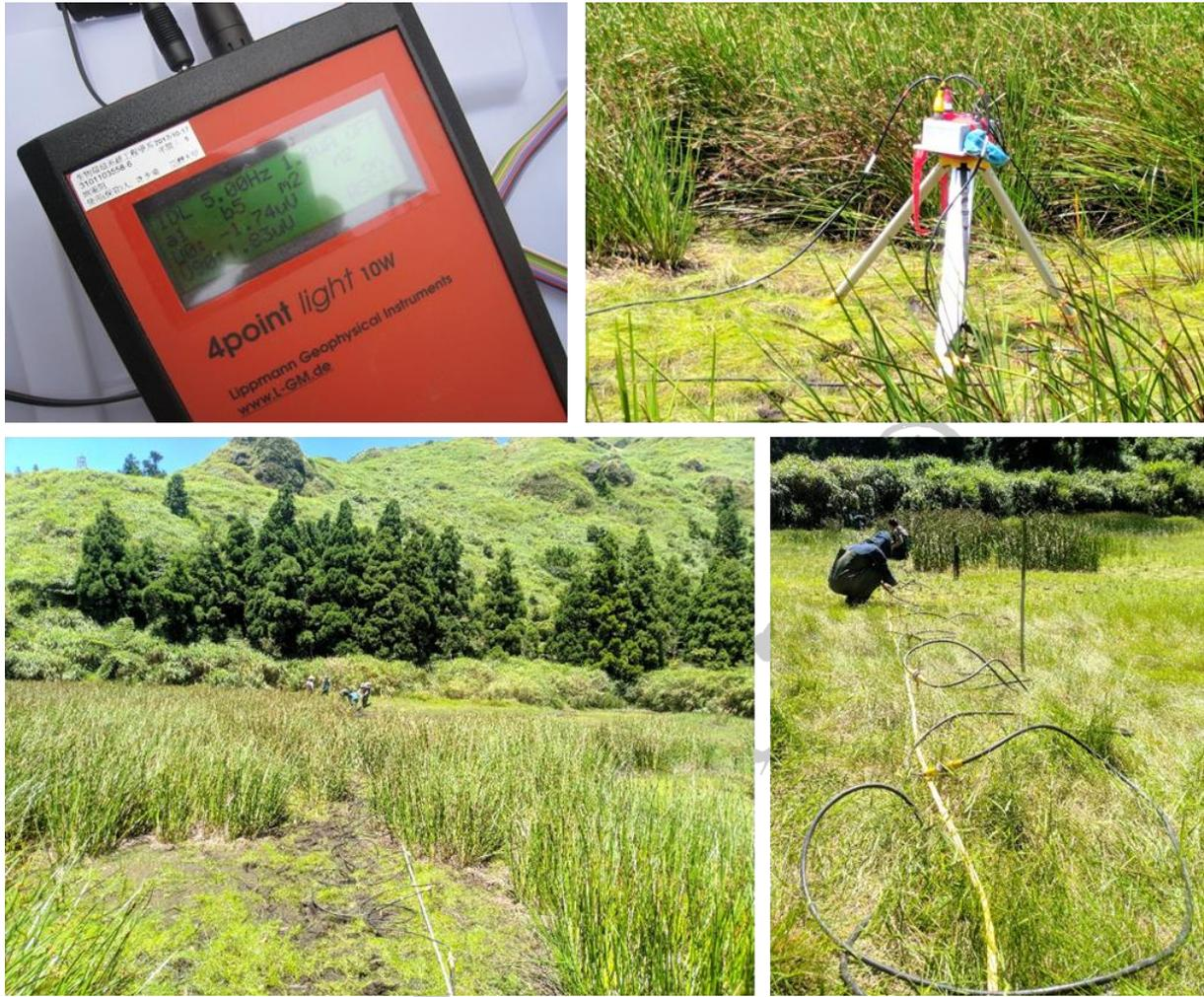
圖 74 地電阻影像剖面法之測勘作業（2020 年 7 月 14 日及 7 月 29 日）
