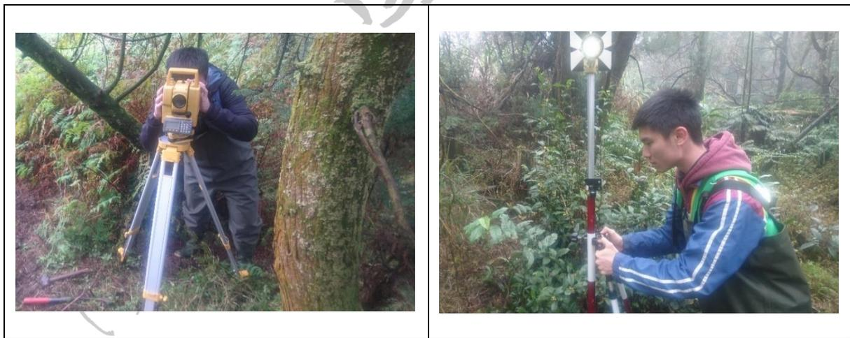
圖 23 電子測距經緯儀進行水井座標及高程調查作業
