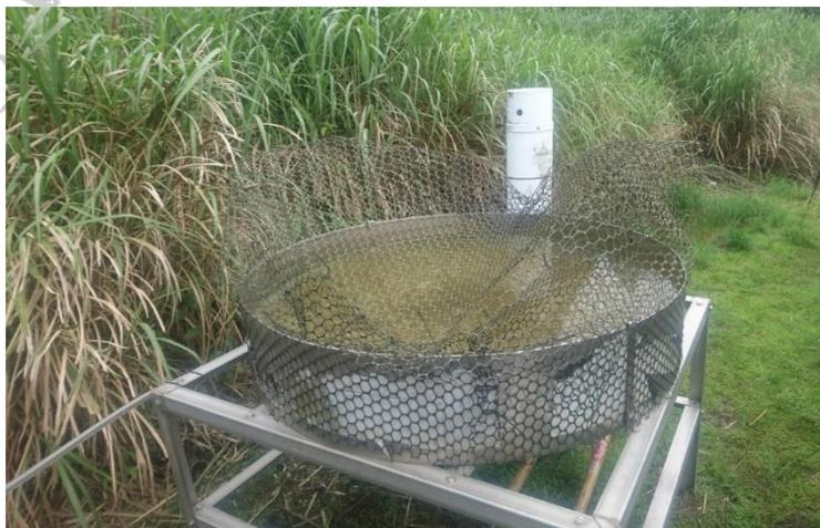
圖 57 蒸發皿及蒸發計
