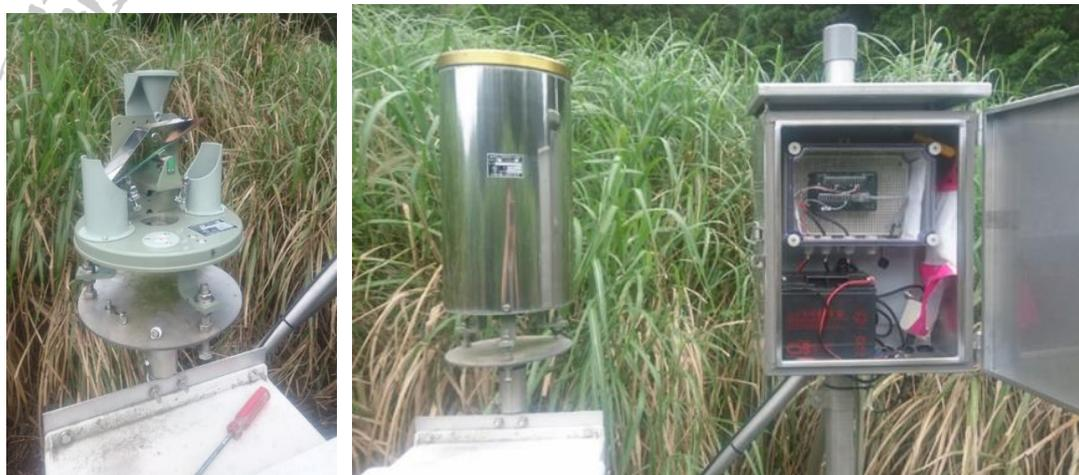
圖 58 傾斗式雨量計及自計水文系統
