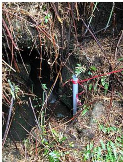
圖 5 C1 裂隙安裝水位計情形
