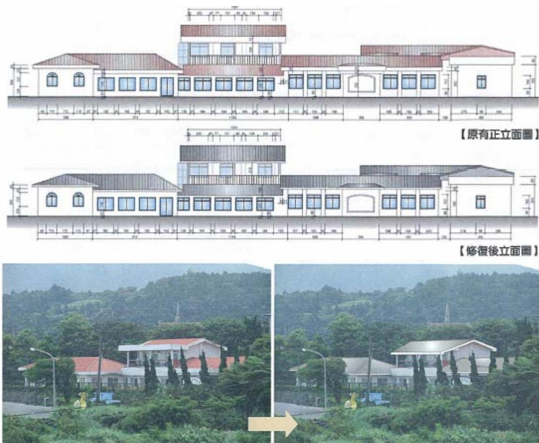
圖 2-10 竹子湖蓬萊米原種田事務所屋頂整建後立面圖及外觀模擬圖
