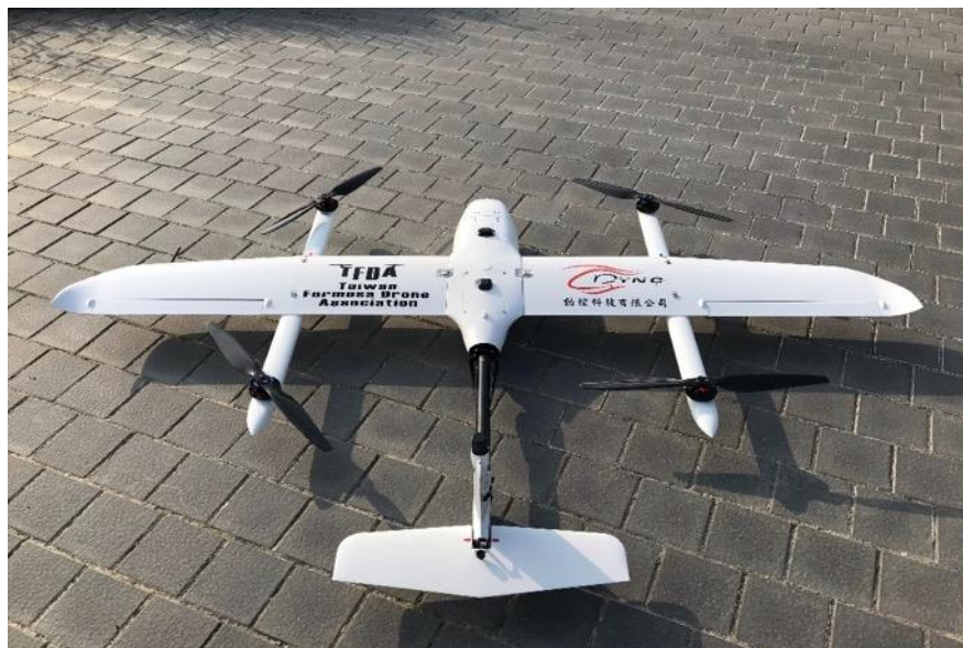
圖 4.3-7、垂直起降固定翼無人機-VTOL。
