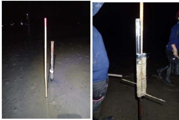
圖 4.3-8、底質沉積速度調查。沙洲變化標杆(左)，泥沙沉降管(右)。
