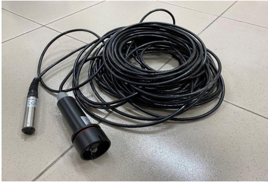
圖 5.1.9-5、自記壓力式水位計(GW2000)。
