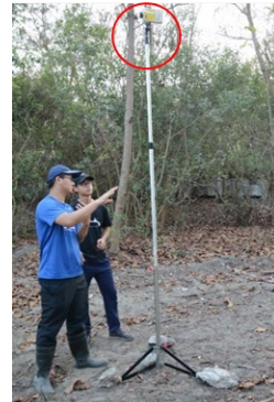
照片 22 Anabat 超音波偵測器架設
