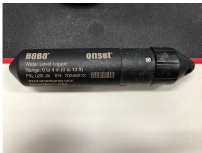
圖 3 HOBO U20L-04 自記式 PP 水位計 (4 米)
