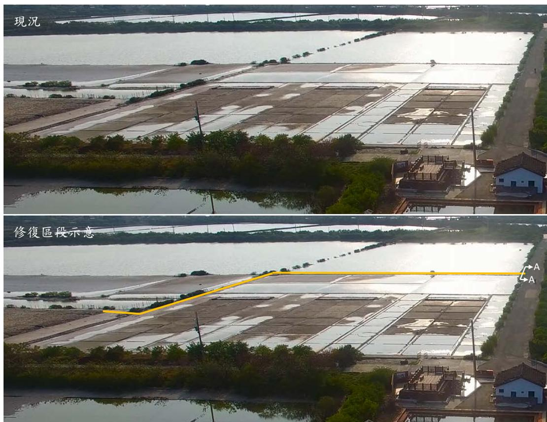
圖 5.4 原規劃曬鹽基地原有土堤與修復培厚區段示意圖
