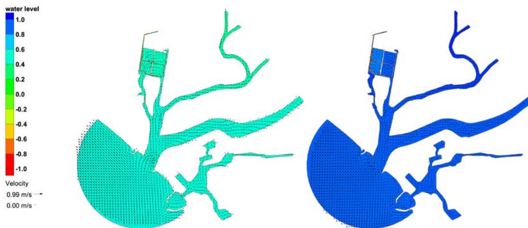
圖 4.5 水位以及流場模擬結果(左:漲潮時段 右:退潮時段)
