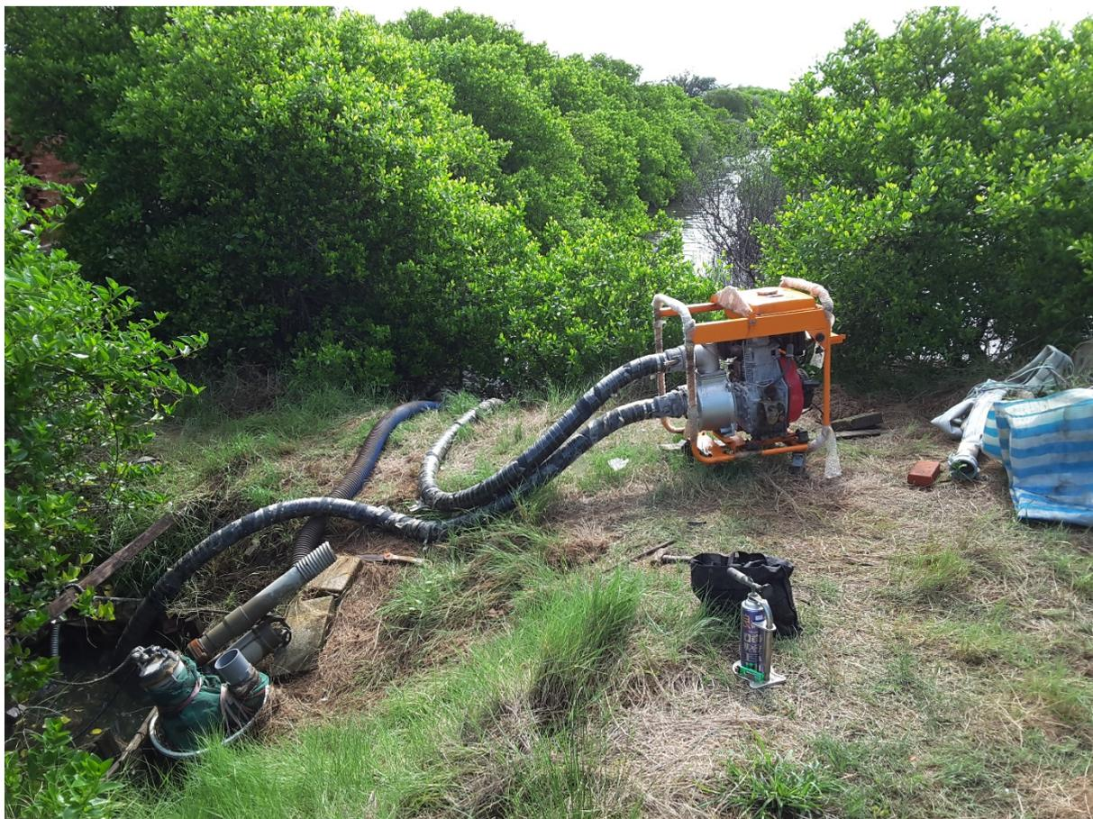
圖 3.15 觀景平台旁小型移動式抽水機
