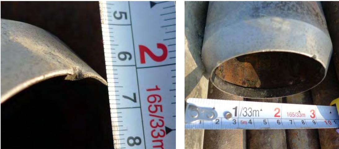
圖37: 鍛鋼內管靴頭因撞擊金屬產生之凹痕
