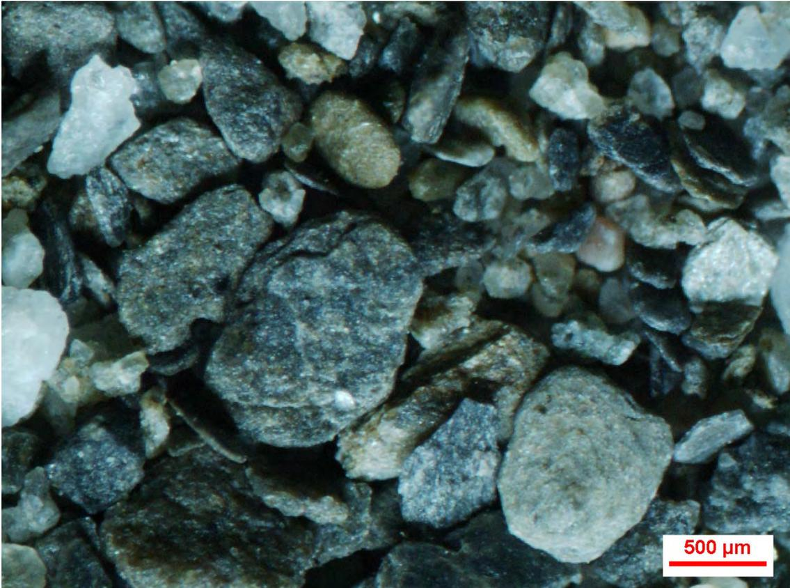
圖17: A3鑽孔可見許多板岩岩屑（扁平之暗色顆粒）之出現（深度0-0.5M）
