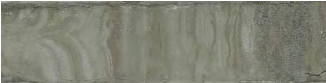
圖39: C1井1.6~1.7公尺間之粉砂層有明顯液化之現象
