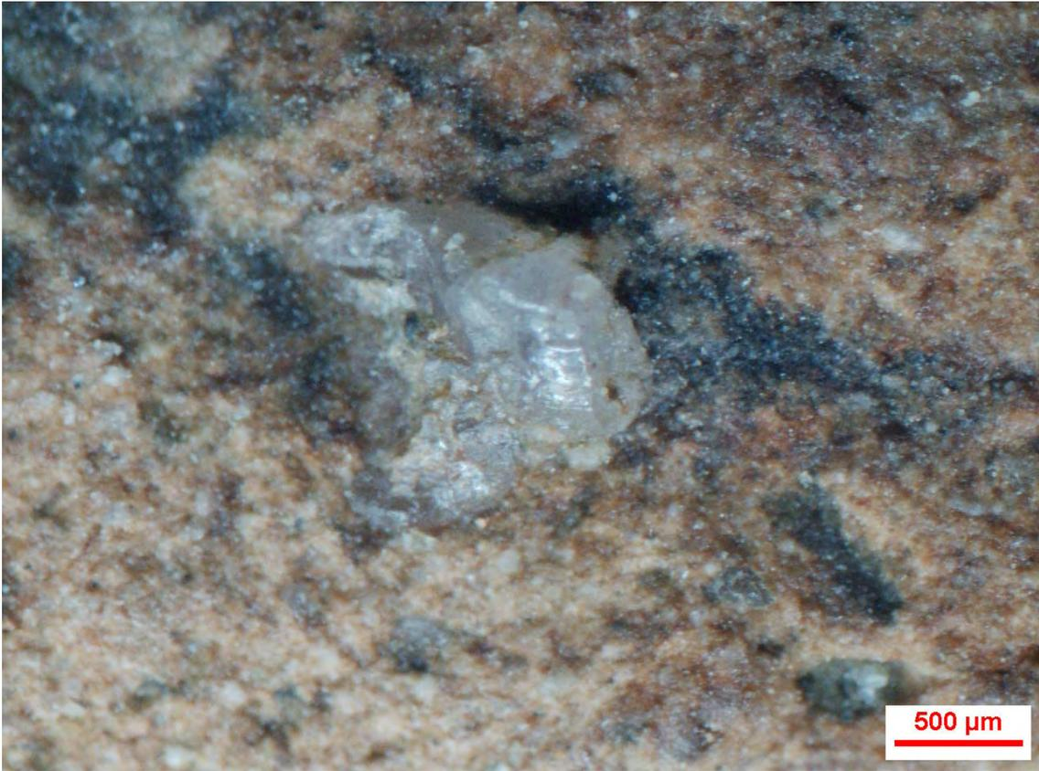
圖50: C4井3.35m處小磚塊上的石英顆粒
