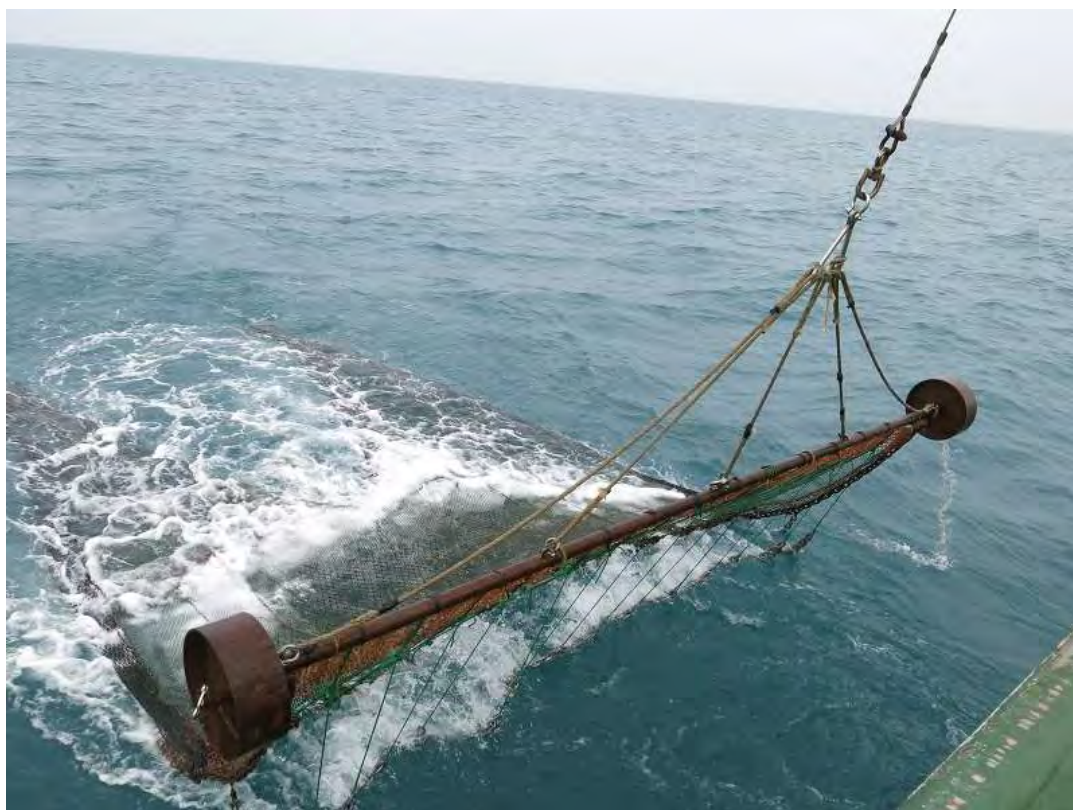
圖 4-2、本計畫使用之海研三號研究船桁桿式底拖網
