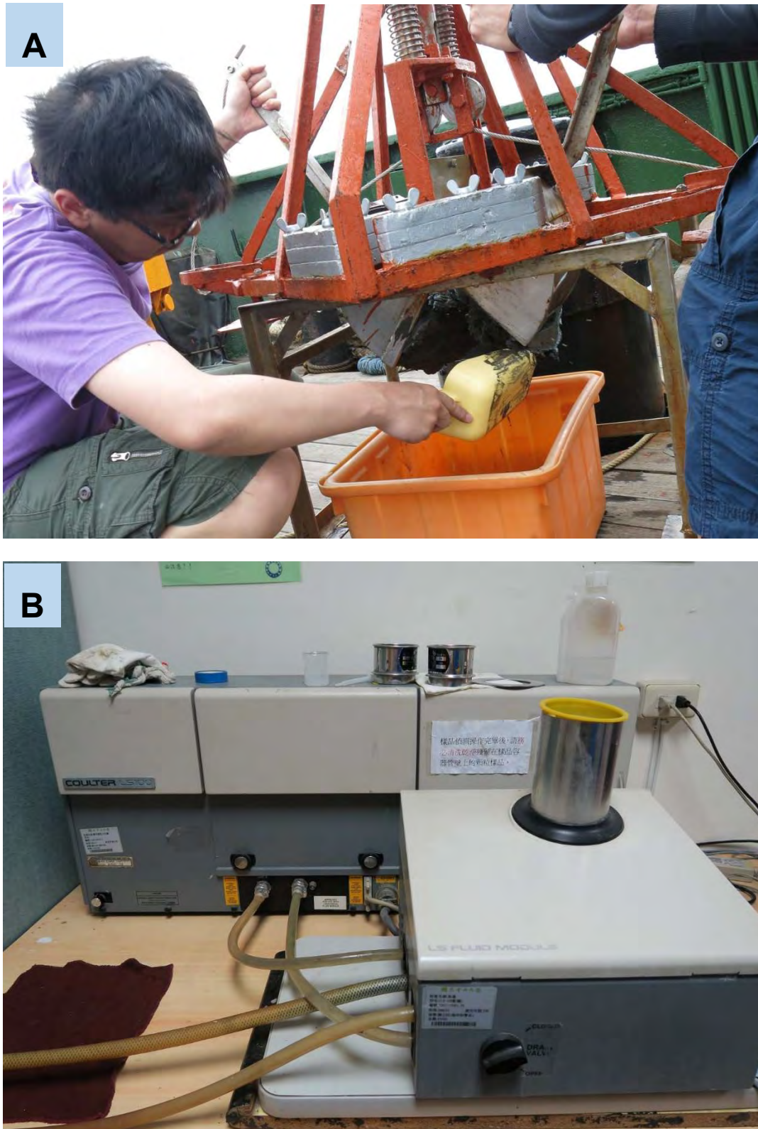
圖 2-3、(A)史密斯-麥金泰採泥器所採集底泥之初步收集及處理； (B)底質粒徑分析使用之 Counter LS-100 型雷射粒徑分析儀。
