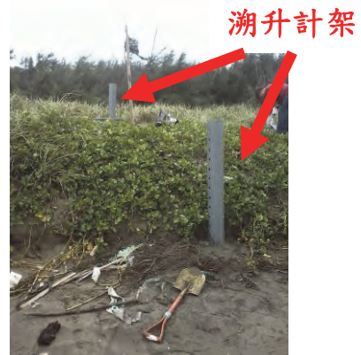
照片5-2-5 溯升計架埋設與固定
