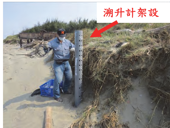
照片5-2-11 布置升計感測器
