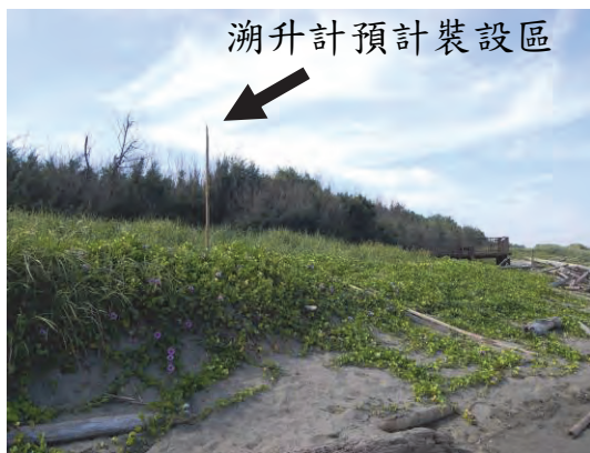
照片4-1-3 木平台北側之颱風波浪溯升水位量測位置(立竿處)
