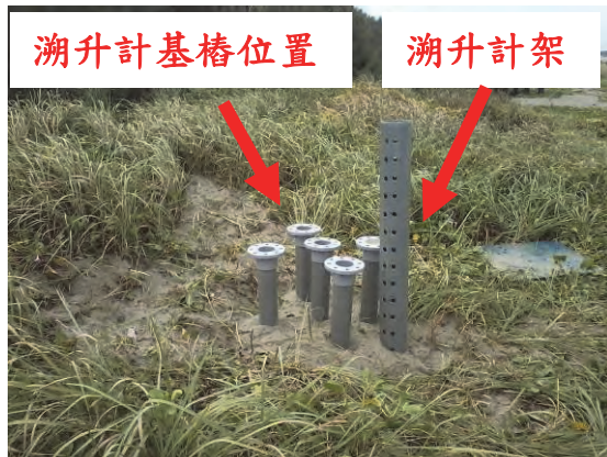
照片5-2-4 基樁及溯升計架
