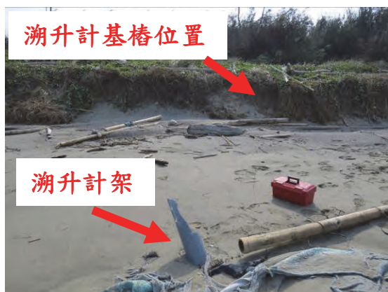
照片5-2-6 基樁及溯升計架
