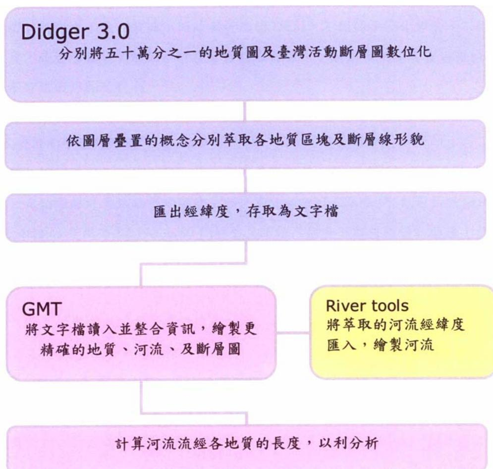
圖 3-10 繪製地圖流程圖。利用各種軟體將不同類型的地圖整合，有助於瞭解河流從上游流到下游的各種資訊（引自高嘉鈴，2010）。
