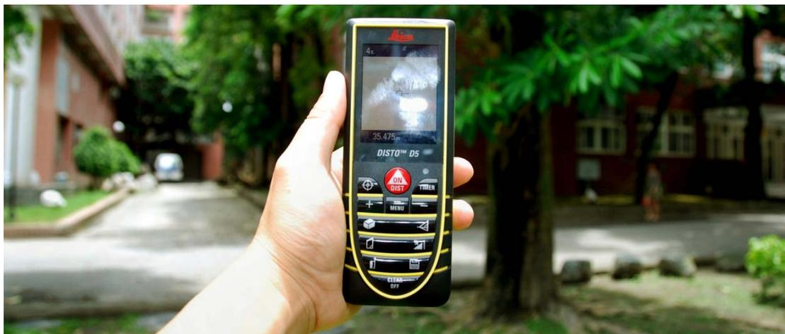
圖 3-4 手持式雷射測距儀。
