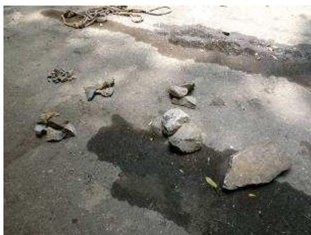
現場試驗用之大理石岩塊，右側最大之長軸長度為 28 公分，重量約 11 公斤；左側三堆石塊為附近路面之凌空墜石。
