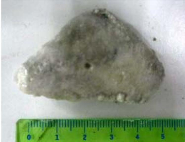
圖四、燕子口隧道變電箱旁結晶中之石灰華 (A); 石灰華表面石灰結晶 (B)。
