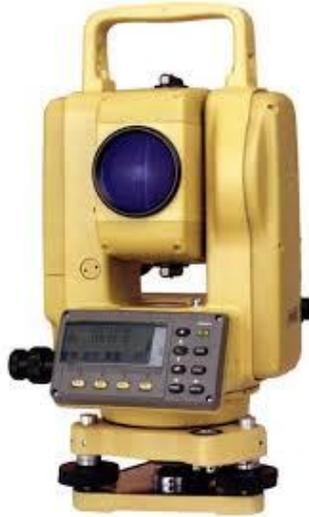
圖 2-1 全測站電子光波測距經緯儀
