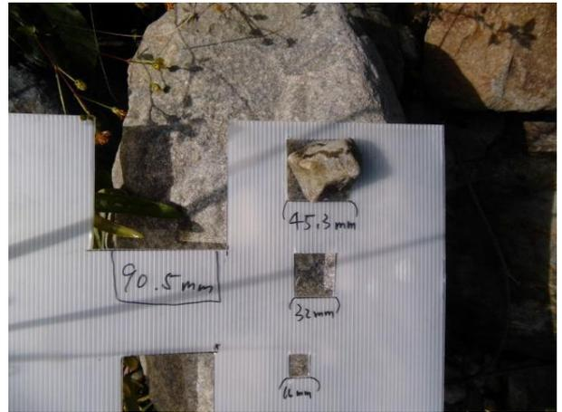
圖 2-3 開口樣板量測粒徑
