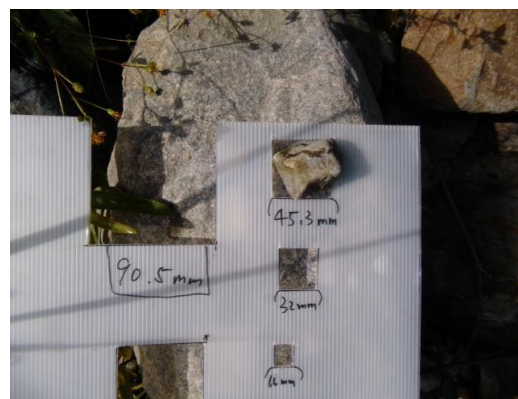
照片 1-2 開口樣板量測粒徑
