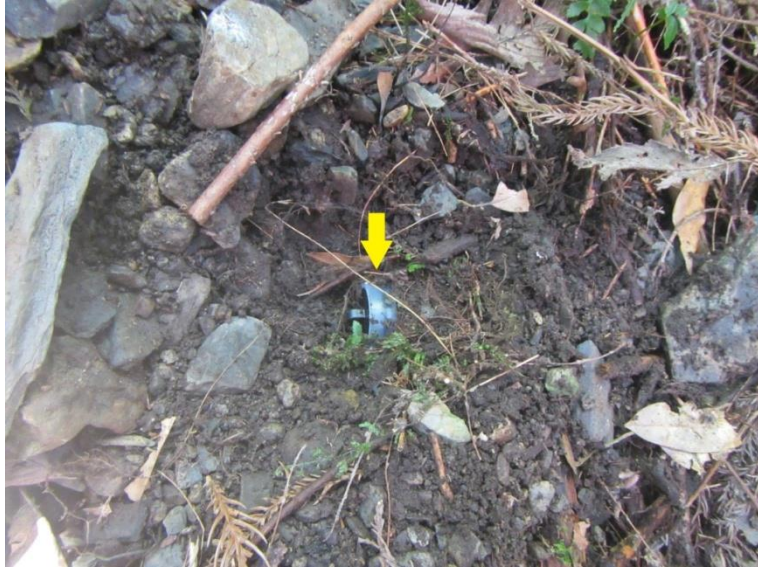
圖 2-5. 野外埋設的溫度自動記錄器(翻開石頭時所看到的埋設現況)。
