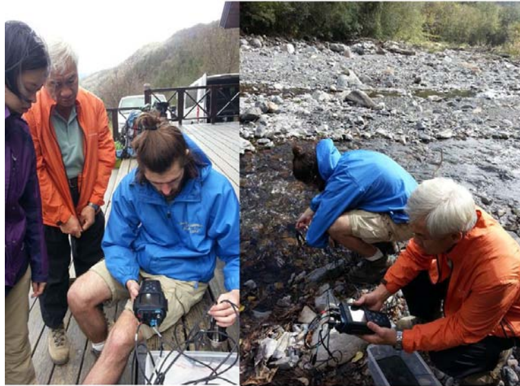
圖 23 2015 年 11 月 29 日團隊利用 Thermo Scientific Orion Star A329 攜帶型水質檢驗器在雪山登山口水池以及七家灣溪量測水體酸鹼度(PH)、電導度、(COND)和溶氧率(RDO)。
