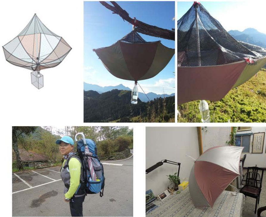
圖 22 工業研究院提供的集水雨傘設計圖、外觀以及 369 山莊後方斜坡雲霧雙層攔截網位置測試的集水現場(2015 年 8 月 18 日~19 日)。
