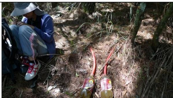
圖 3-8. 土壤滲漏水裝置完成情況。
