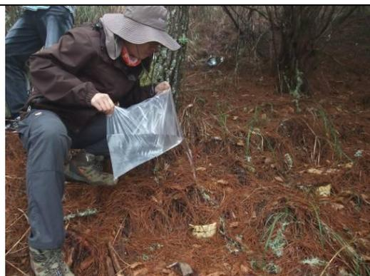
圖 3-9. 模擬降雨收集土壤滲漏水之情況。
