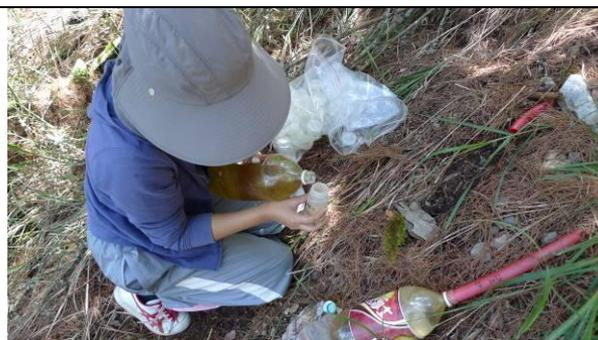
圖 3-10. 收集土壤滲漏水樣本之情況。
