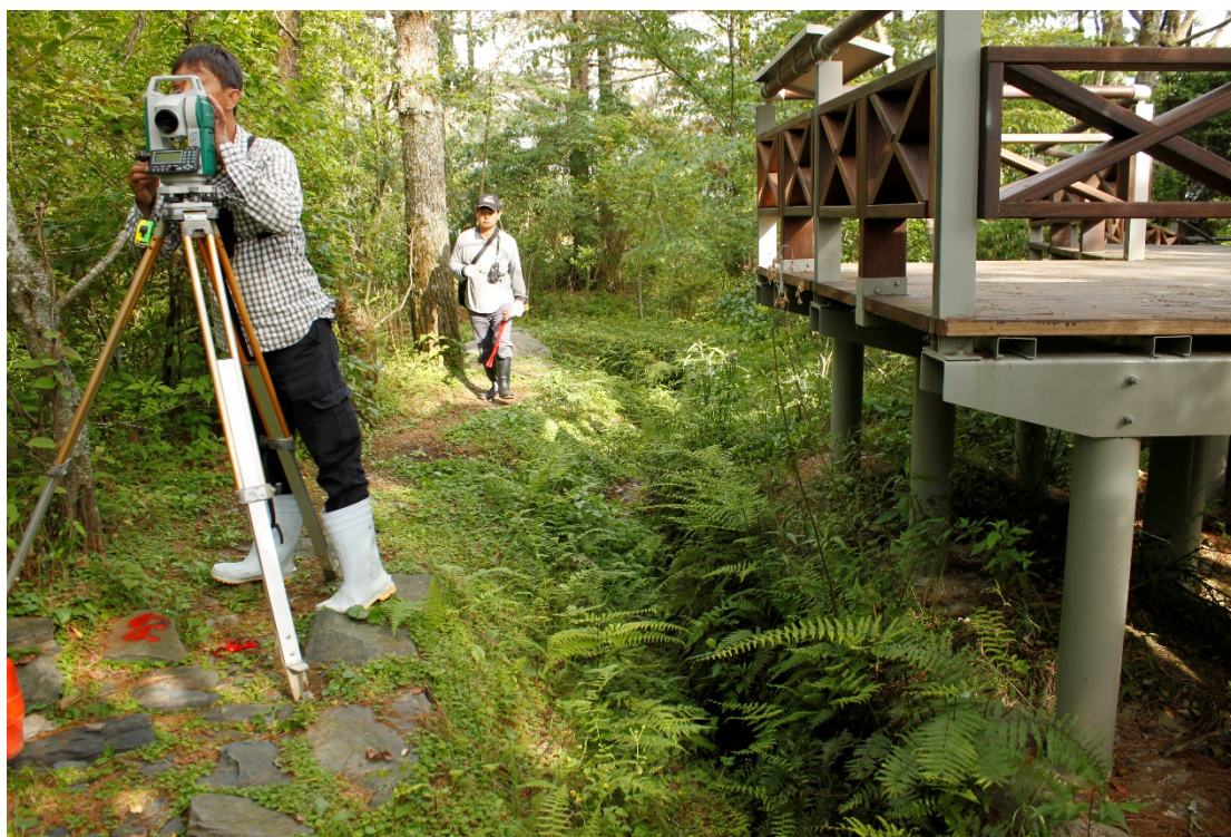
圖 3-1-2. 委託專業測量公司，以電子經緯儀測量觀霧山椒魚試驗棲地
