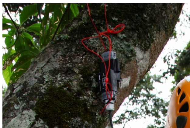
圖六、樹冠層、地被層各設置 HOBO 微型氣象儀器照片
