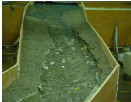
照片 5-17 渠道沖刷後
