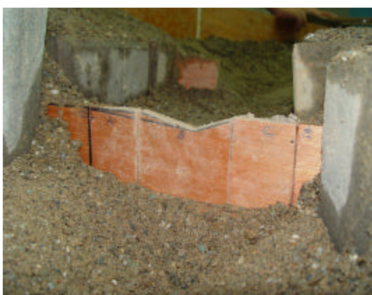
照片 5-10 鋪設壩型體模型
