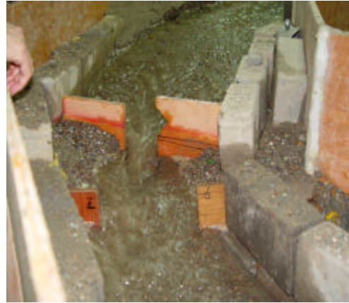
照片 5-15 拆除壩體
