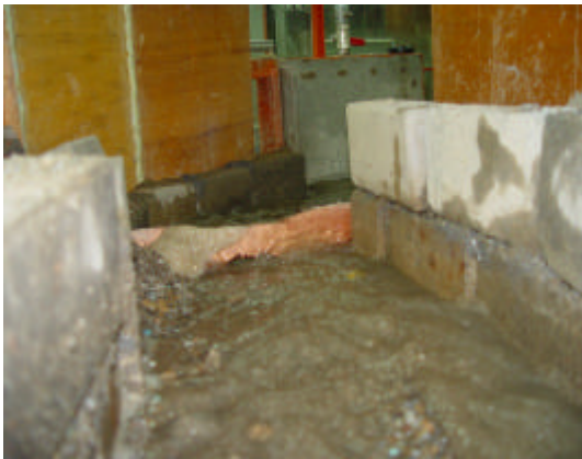
照片 5-16 渠道沖刷中
