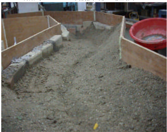
照片 5-12 夯實之土層
