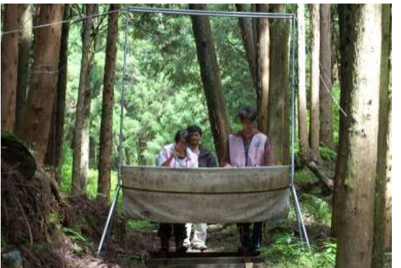
圖十七、豎琴網架設於瀑布步道的步道階梯
