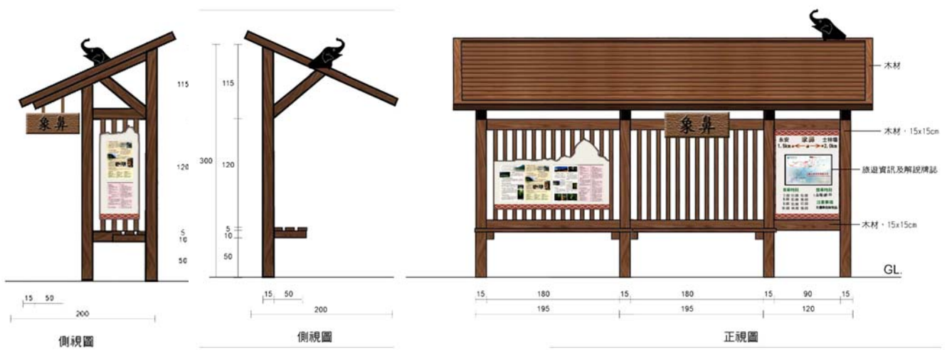
圖 5-41 A2-導覽地圖 2(結合遊客轉運站計畫二級停靠站) 牌示示意圖 (以 23-象鼻聚落村辦公室附近三向路口)
