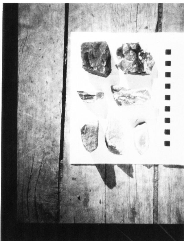
照片 5：369 山莊剖面的碎石屑，呈次稜角狀，形狀多類似熨斗的五角形
