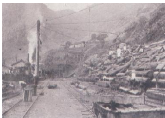
照2-1-6 土場為山區運材與平地運材的轉運站 照片來源：台灣的林業，2006
