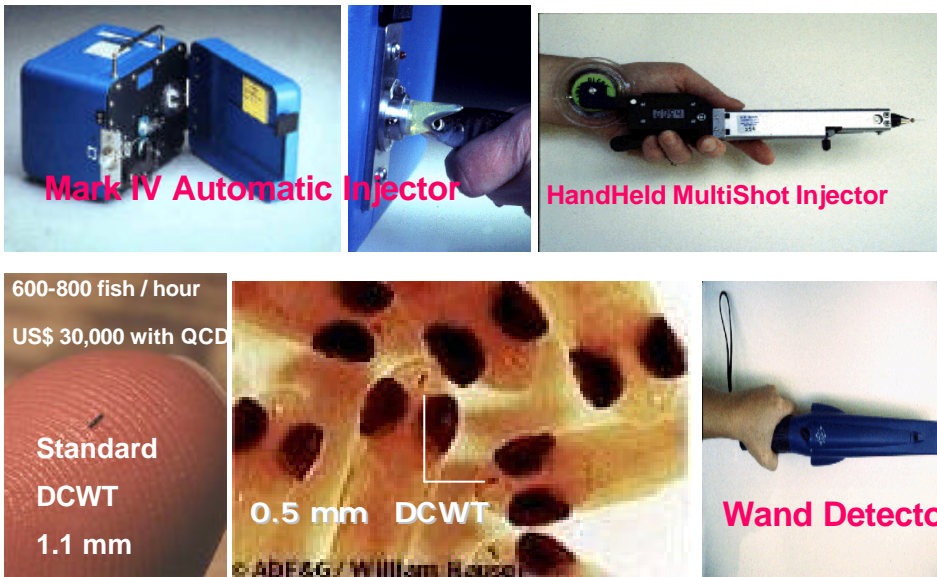
圖二 十進位編碼線圈標識系統
