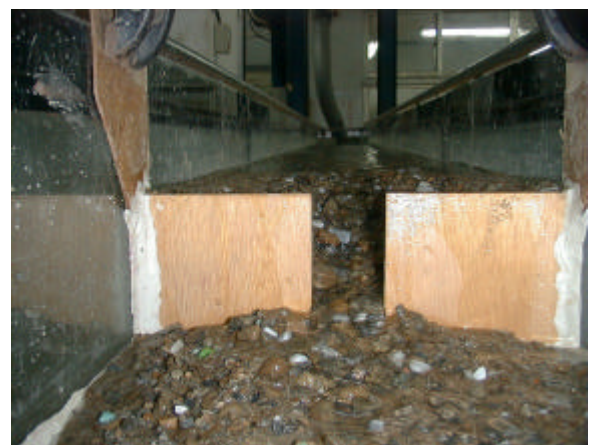
圖 4-7：防砂壩缺口試驗(剛開始下游堆積)
