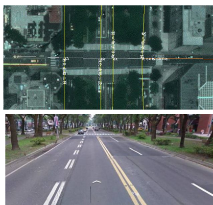
圖 10、具實體分隔(或快慢車道分隔者)之道路中線繪製_道路中線須分別繪製
