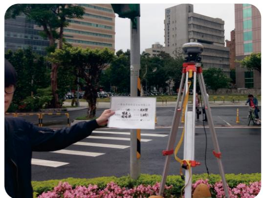
▲ 圖 4-8 一等水準點幾何高檢測作業情形
