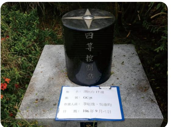
▲ 圖 4-11 美化控制點維護作業情形
