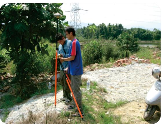
▲ 圖 4-29 台電鐵塔用地預為分割實地測量情形
