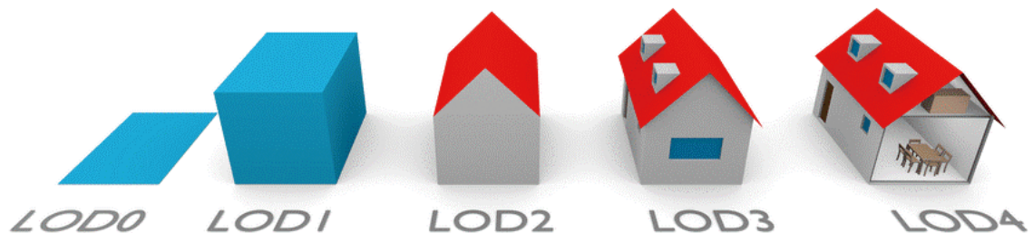
圖 5 CityGML 建物 LOD0-LOD4 成果示意圖
