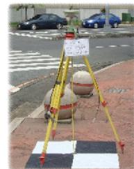
圖二 校正標 GNSS 衛星定位儀觀測
