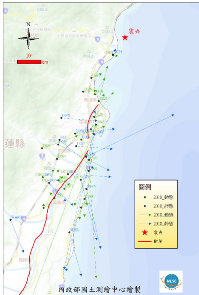
圖 3：震後使用即時動態定位測量基本控制點成果較差示意圖
