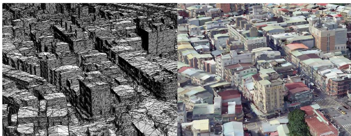
圖 4-10 純 DSM 網格面(左) 與貼敷真實影像紋理後的 DSM (右)
