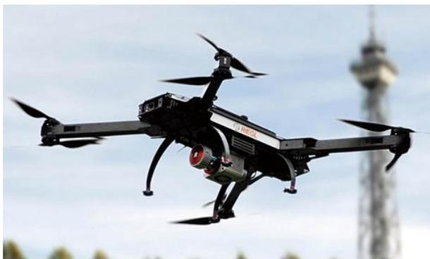
圖 4-1 遙控無人機搭載光達掃描儀
