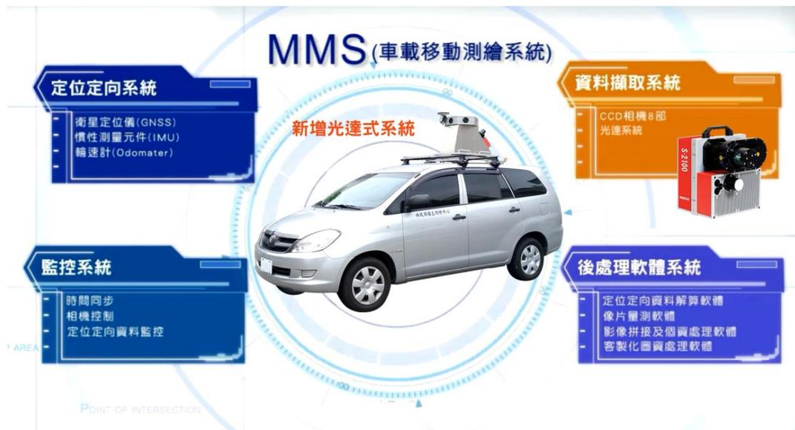
圖 4-3 本中心光達式車載移動測繪系統
