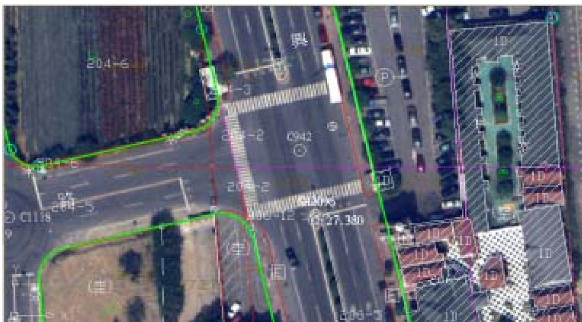
圖 4-105 港子坪段第 10、11 幅接合處轉換後套疊影像圖
