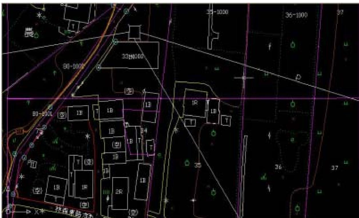
圖 4-68 崎頂段第 15、16 幅接合處坐標轉換結果套疊地形圖
