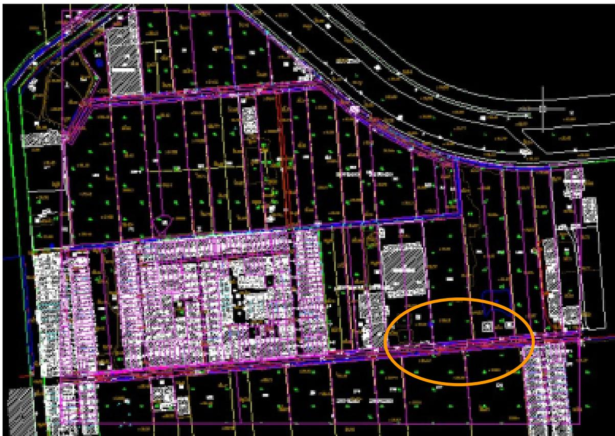
圖 4-18 湖內段第 5 幅轉換後地籍地形套疊圖(紅色線:地籍線 黃色線:地形線)
