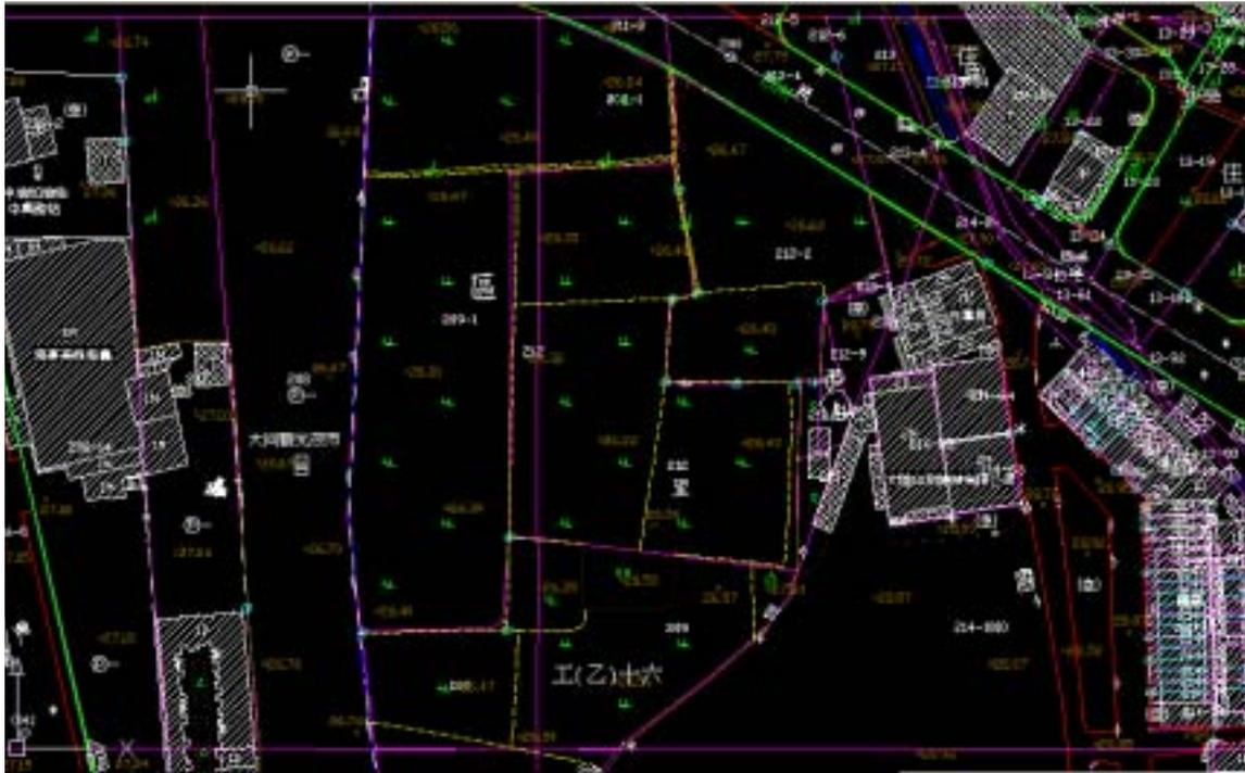
圖 4-100 港子坪段第 5 幅地籍地形套疊圖(紅色線:地籍線 黃色線:地形線)
