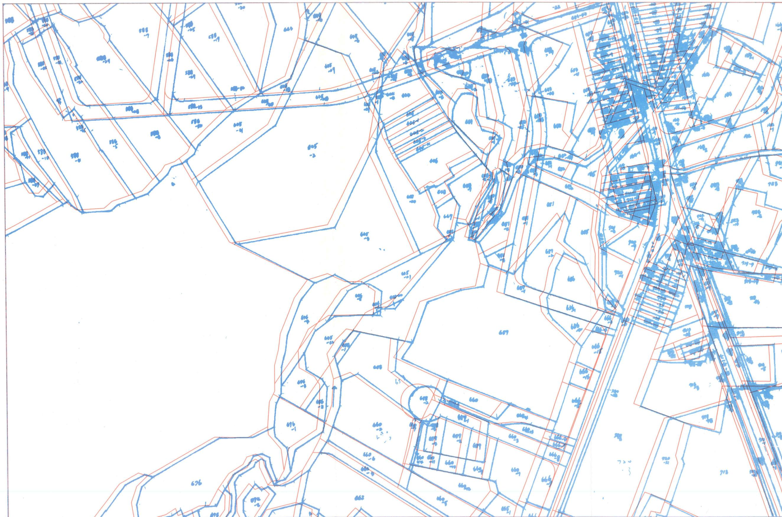
附圖11 魚池重測區重測前後圖形套疊（採直接內插法）
