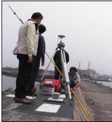
圖 3 基地站架設檢查
