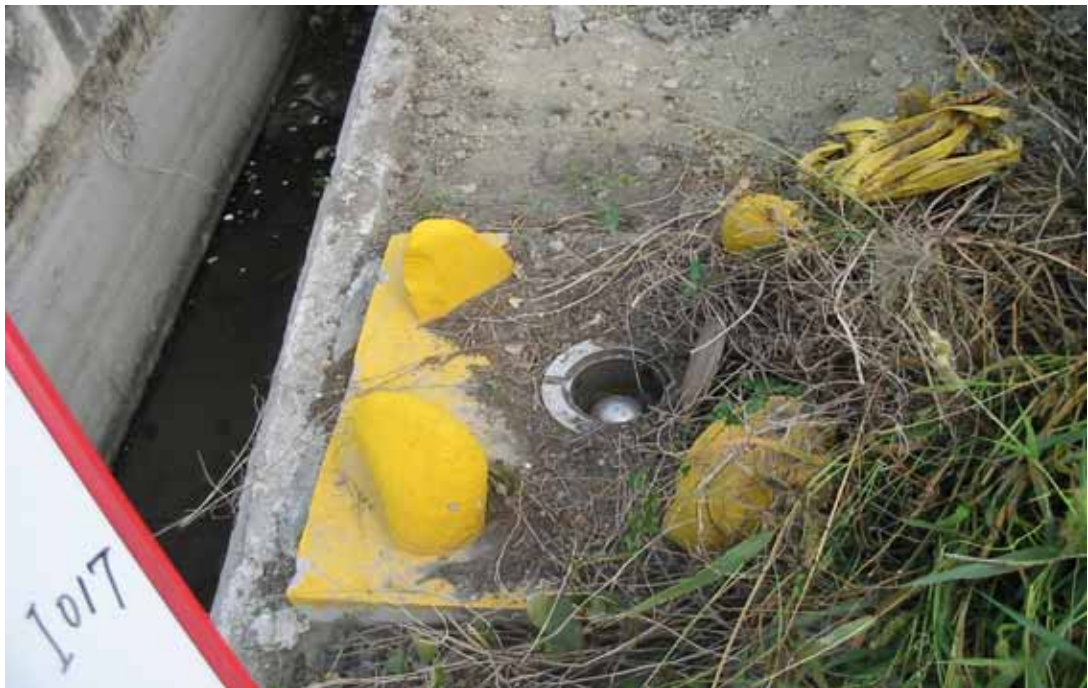
圖 3-4：一等水準點 I017 GPS 外業觀測照片及點位近照
