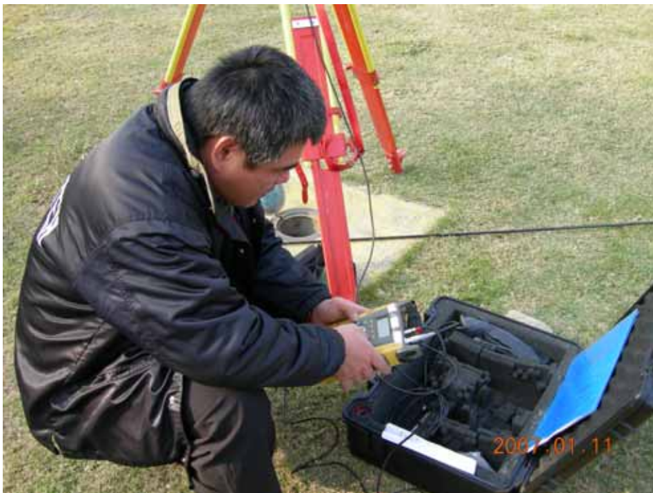
圖 3-5：一等水準點 X101 GPS 外業觀測照片及點位近照
