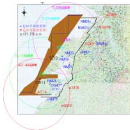
圖 2 GPS-RTK 無線電範圍示意圖
