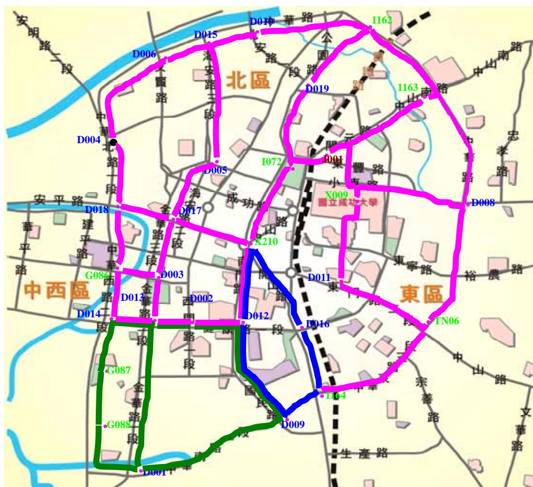
圖 2-1 二、三等水準測量作業規劃路線圖
