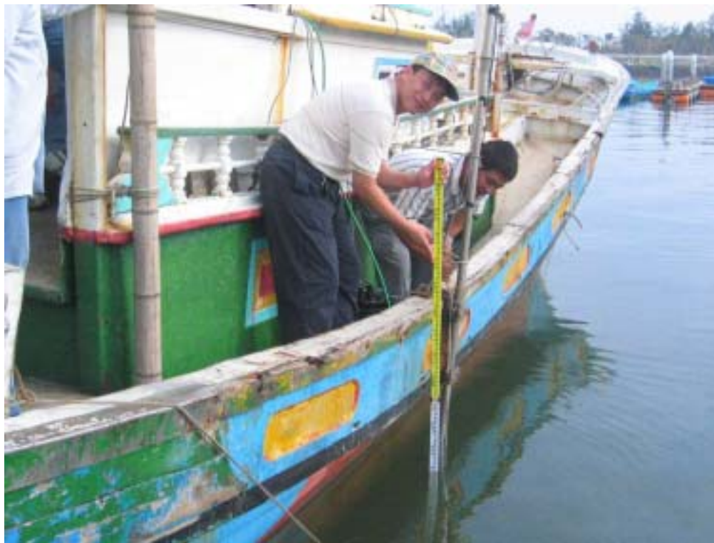
測深儀音鼓以檢校板率定作業情形
