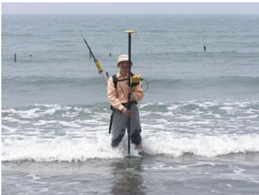
以 RTK 辦理檢測作業情形
