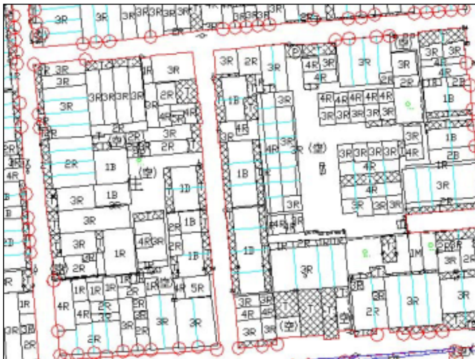
圖 4.8 湖內小段地形圖與現況測量成果套合之一隅(公司)
