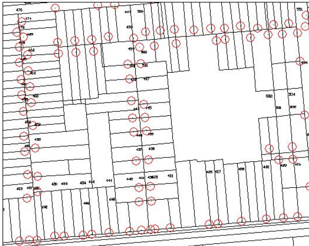
圖 4.9 湖內小段地籍圖與現況測量成果套合之一隅(地政所)
