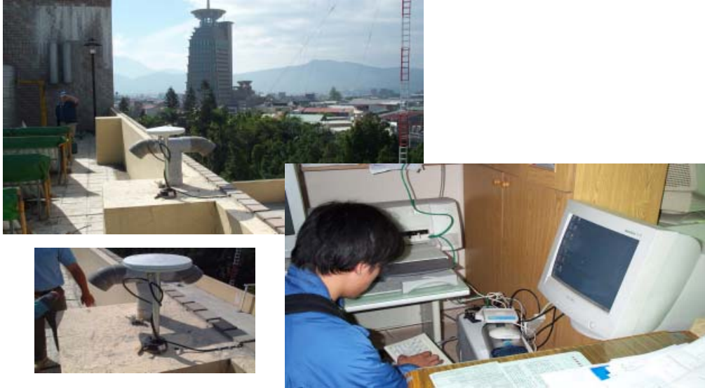
圖 5-5 埔里地政事務所電腦、接收儀、天線盤設置地點及設站情形
