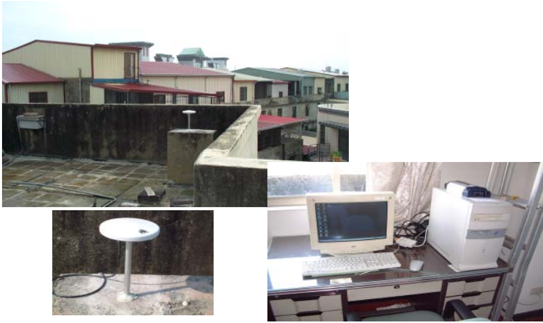
圖 5-1 安南地政事務所電腦、接收儀、天線盤設置地點及設站情形
