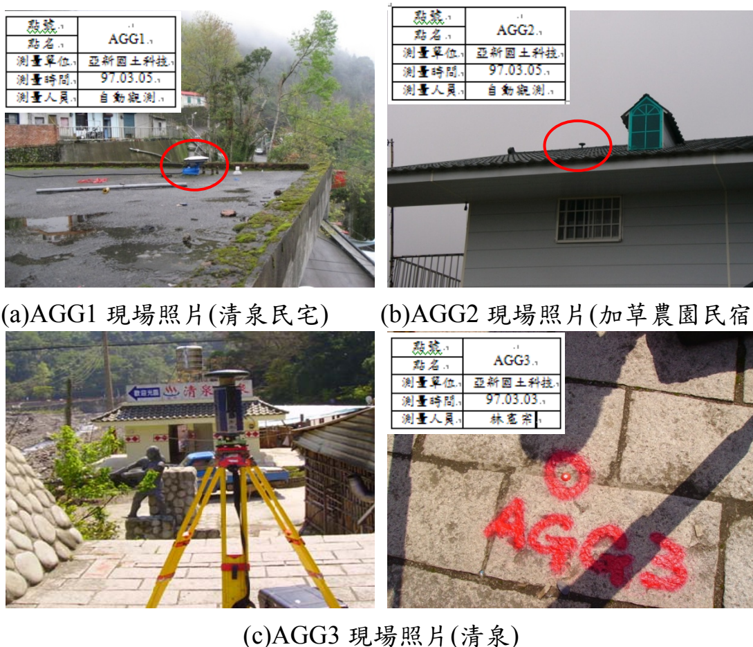
圖 2-16 中高海拔山區地面 GPS 基站現場照片
