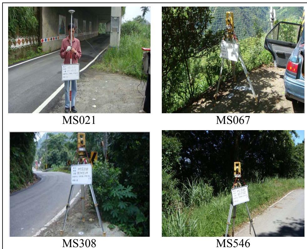
圖 5-37 中高海拔山區橫斷面檢核現場照片
