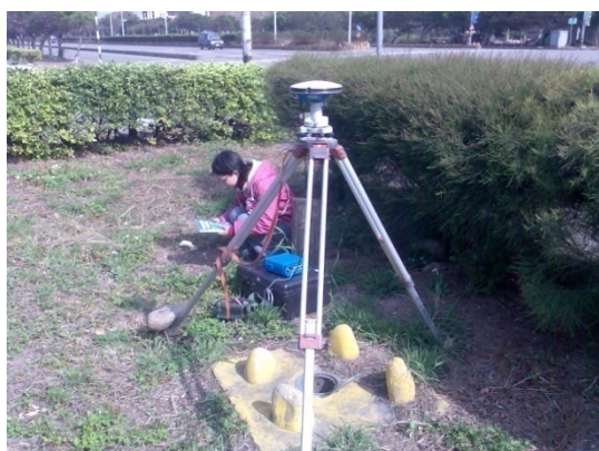
圖 2- 15 彰化測區 GPS 基站現場照片_2
