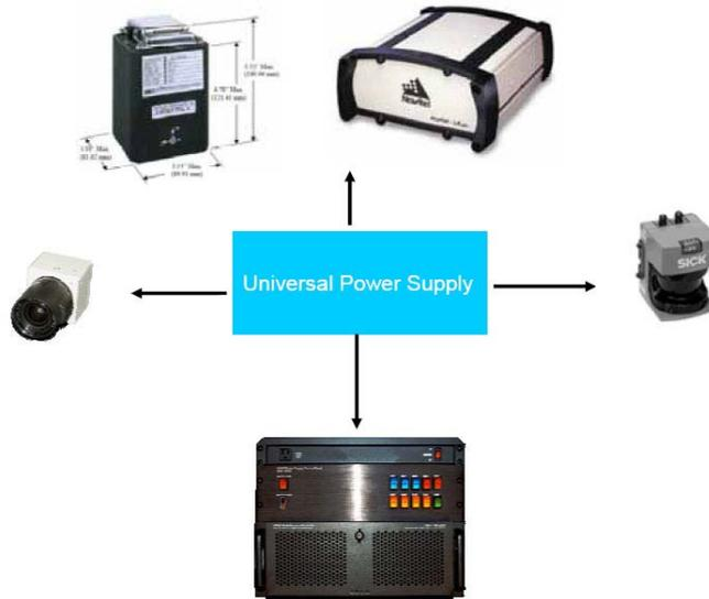
圖 6.2 測量車多感器平台之通用電力系統
