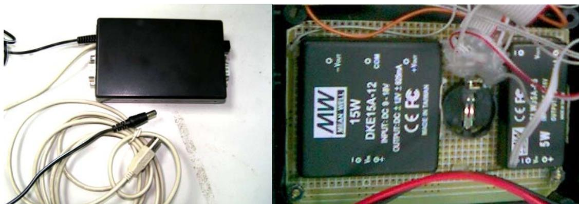
圖 3.24 電源轉換電路照片
