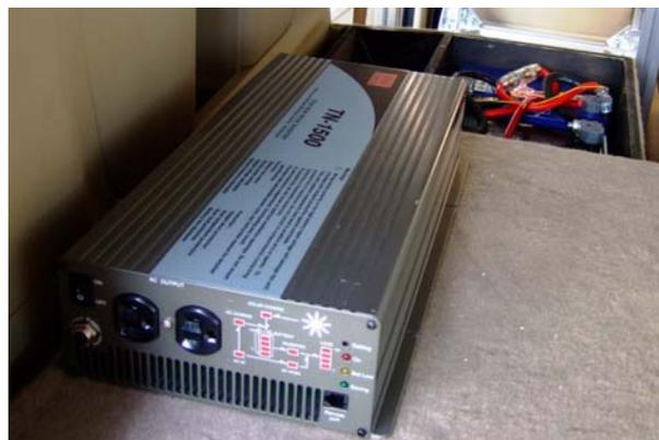
圖 6.4 測量車多感器平台之通用電力系統（二）
