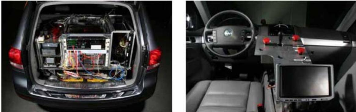
圖 6.5 測量車多感器平台之內部空間配置範例
