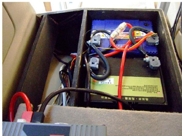
圖 6.3 測量車多感器平台之通用電力系統（一）
