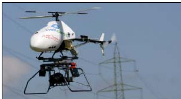
圖 7.27 旋翼 UAV 攝影測量系統範例
