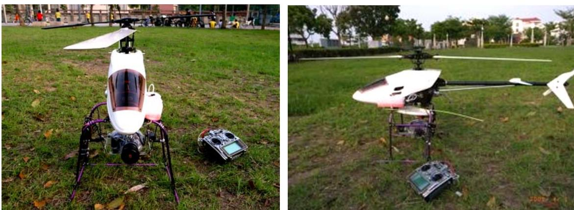
圖 3.12 旋翼型 UAV—KYOSHO 60 級照片
