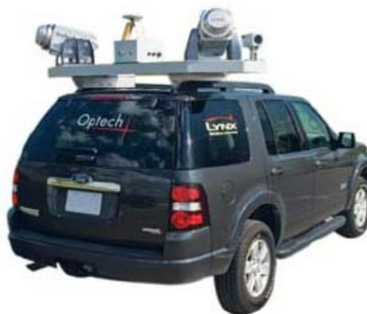
圖 2.35 Optech 的測量車 Lynx Mobile Mapper
